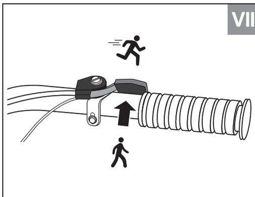
11. Сцепление и регулировка оборотов двигателя
